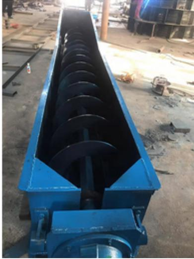
轮式洗砂机是制砂设备中必不可少的设备,可以除去砂子的石粉、泥土、杂质,从而对砂子的质量进一步提高,符合高标准的工程建筑,具有洗净度高,结构合理,产量大,在洗砂过程中砂子流失少,采用水传达部件隔离,也可以用于冶金、建材、水电等行业的洗选、分级、除杂等作业,适合于粗粒度、细粒度物料的洗选,确保了效果好、耐用、脱水等效果,保持了稳定的特点.
