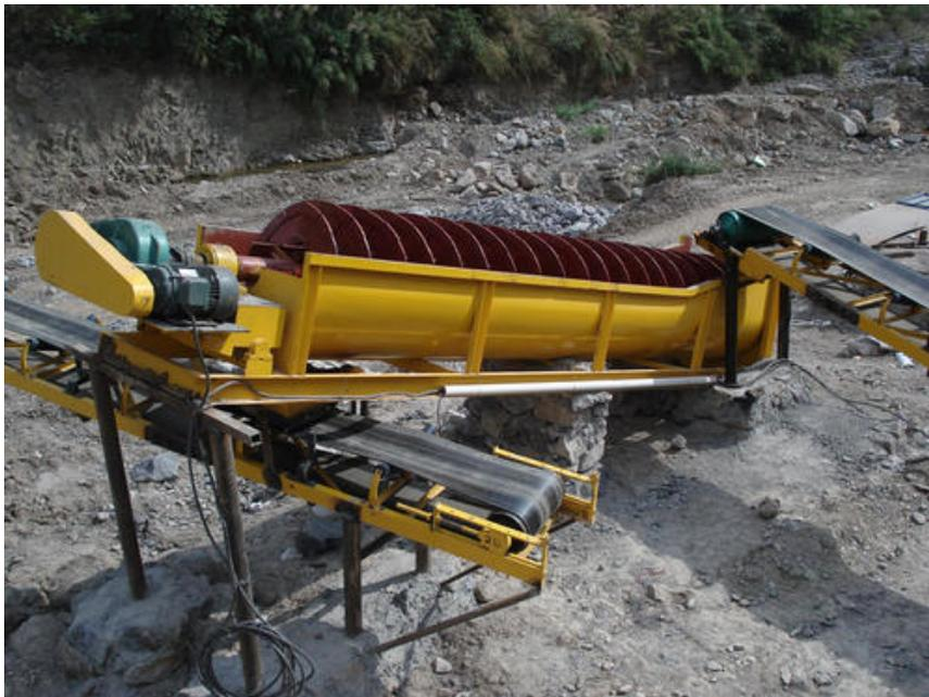
轮式洗砂机是制砂设备中必不可少的设备，可以除去砂子的石粉、泥土、杂质，从而对砂子的质量进一步提高，符合高标准的工程建筑，具有洗净度高，结构合理，产量大，在洗砂过程中砂子流失少，采用水传达部件隔离，也可以用于冶金、建材、水电等行业的洗选、分级、除杂等作业，适合用于粗粒度、细粒度物料的洗选，确保了效果好、耐用、脱水等效果，保持了稳定的特点。
